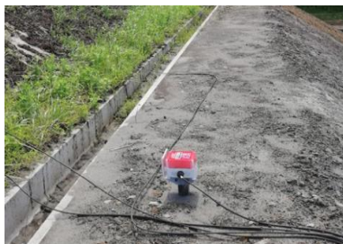
設置した移動局（地面に設置の赤い機器）
