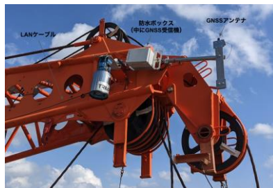
ジブ先端に装着した機器の様子
