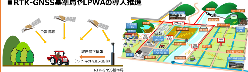
RTK-GNSS基準局の導入 農村における情報通信環境整備のイメージ
