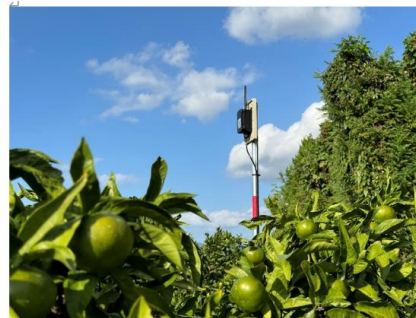
みかん畑に設置した土壌水分センサー(送信部) ㊦
