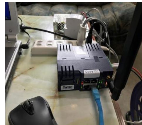
VPNルータ(Ewon製Cosy 131-4G APAC) SIMカードを本体に挿入してインターネット通信
