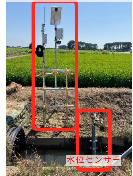
用水路へ水位センサー および静止画カメラの併設
