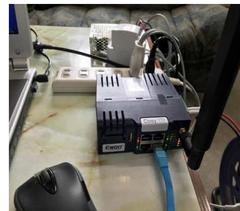
VPNルータ(Ewon製Cosy 131-4G APAC) SIMカードを本体に挿入してインターネット通信
