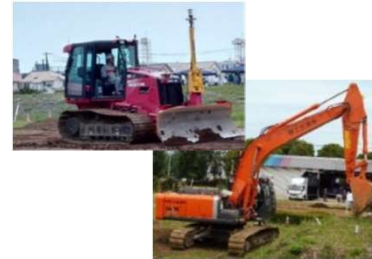
MGバックホウによる丁張不要 施工等
