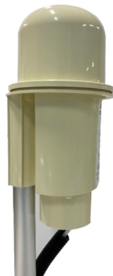
通信ボックス部 (単三電池2本で動作)
