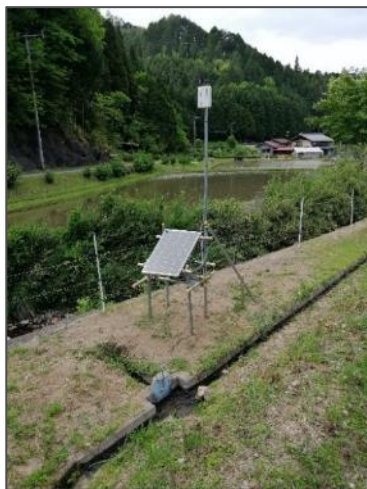
5/26 に下呂市で設置した ソーラー型LoRaWANゲートウェイ
