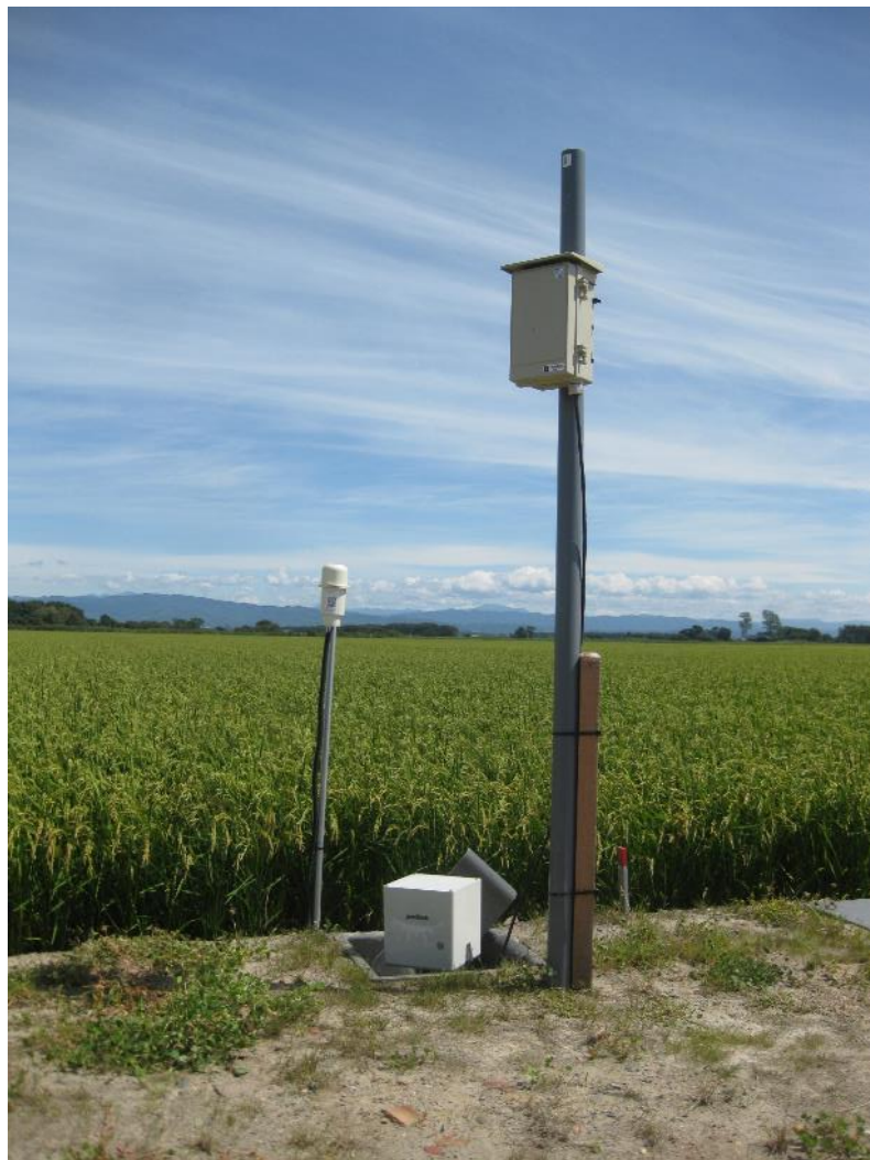
北海道美唄市 自動給水弁と水田センサー
