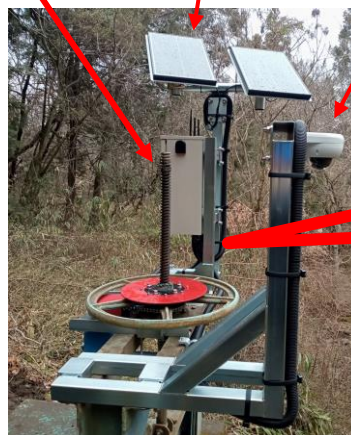
IOTゲートウェイ (ボックス内) ソーラーパネル 監視カメラ
