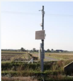
水位計測装置
