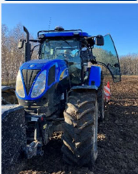
RTK補正データを利用した自動操舵システム搭載トラクター
